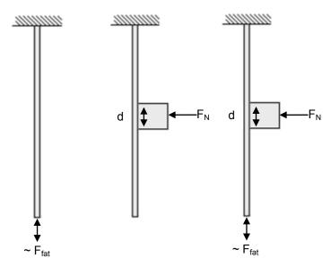
Figure 3: a) Fatigue b) Fretting c) Fretting fatigue
